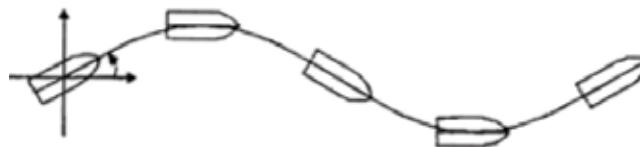
Şekil 16. Düzlemsel hareket mekanizmasının hareket modları (Can, 2014).
