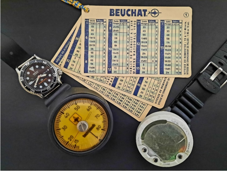
Şekil 22. Dekompresyon üçlüsünün (dalış saati, derinlik göstergesi, MN90 dekompresyon tablosu) yerini günümüzde dalış bilgisayarı (sağ alttaki alet) aldı. (Fotoğraf: Hakan Kabasakal arşivi).
