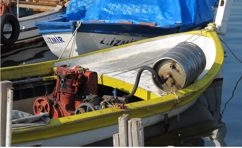
Şekil 6. Maddi yetersizlikle oluşturulan doğaçlama nargile donanımı artizan dalgıcın kıvrak zekâsını ele veriyor. Kayığın makinesinden güç alan kompresörün bastığı hava çelik bira fiçisinde depolanıyor. (Fotoğraf: Hakan Kabasakal arşivi).
