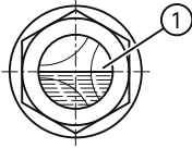
Resim 12-33 Yağ gözlem camındaki yağ seviyesi
