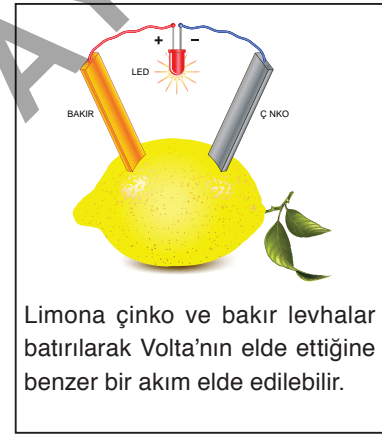
Volta tarafından geliştirilen ilk pilin modellenmesi
