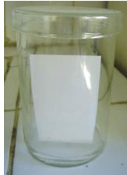
Boyarmaddelerin ayrımını sağlayan ince tabaka kromatografisi tankı, hareketli faz ve duran faz.
