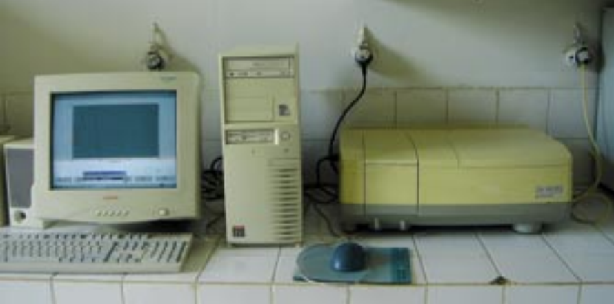
Shmadzu 1610 PC spektrofotometri. (Boyarmadde analizleri yapılan cihaz.)
