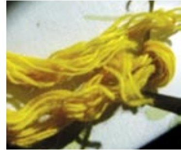
\text{SnCl}_2 \cdot 2\text{H}_2\text{O} mordan kullanılarak aspir ile boyanmış yün.
