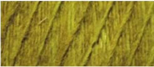
KAl(SO_4)_2 \cdot 12H_2O mordan kullanılarak dağlama ile boyanmış yün.
