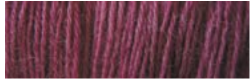
KAl(SO_4)_2 \cdot 12H_2O mordan kullanılarak, Ağrıdağı kermesi ile boyanmış yün.
