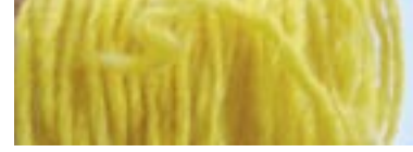
SnCl_2 \cdot 2H_2O mordan kullanılarak, ıhlamur yaprağı ve çiçeği ile boyanmış yün.
