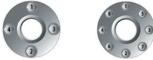
Şekil 146 Flanş 4-8 Cıvata Sayısına Göre Tork İşlem Sırası
