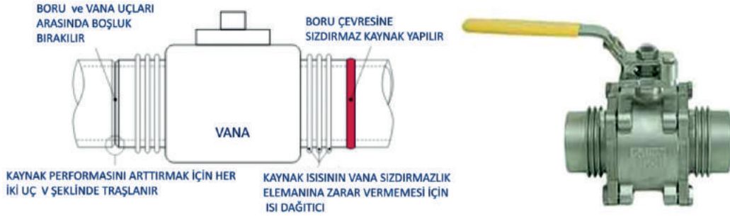
Şekil 282 Alın Kaynaklı VANA-BORU Bağlantısı
