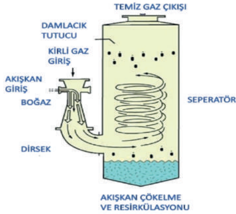
Şekil 203 Venturi Tip Yıkayıcı Prensi Şeması
