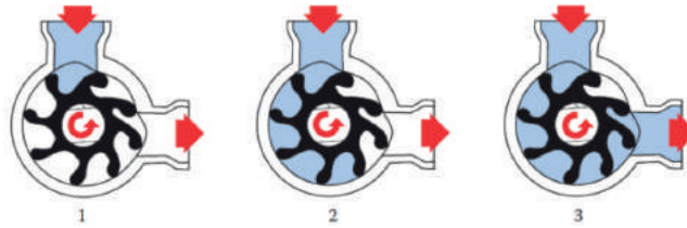
Şekil 116 Esnek Çarklı Pompa Çalışma Prensipleri
