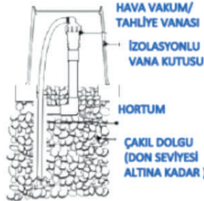
Şekil 180 Vana Montaj Tip Detayı
