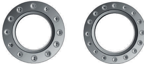
Şekil 147 Flanş 12-16 Cıvata Sayısına Göre Tork İşlem Sırası
