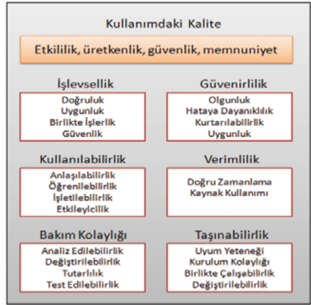
Şekil-2 TS ISO/IEC 25051 Kalite Modeli
