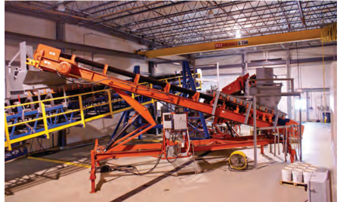
Martin'in Dökme Malzeme Taşıma Yenilik Merkezindeki üç parçalı bir kapalı devre konveyör sistemi, tam ölçekli malzeme taşıma testine imkan verir.
