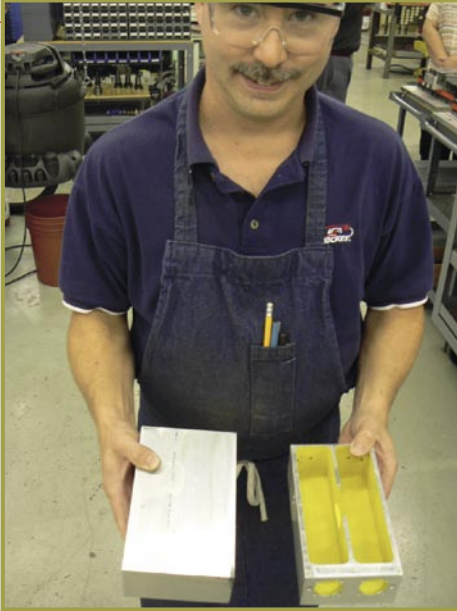
■ Dale Newton, üretim safhalarını gösteriyor: bir alüminyum külçesinden (solda) filtre, tüm konektör ve vida bağlantılarını hazır olarak meydana getiriliyor.
