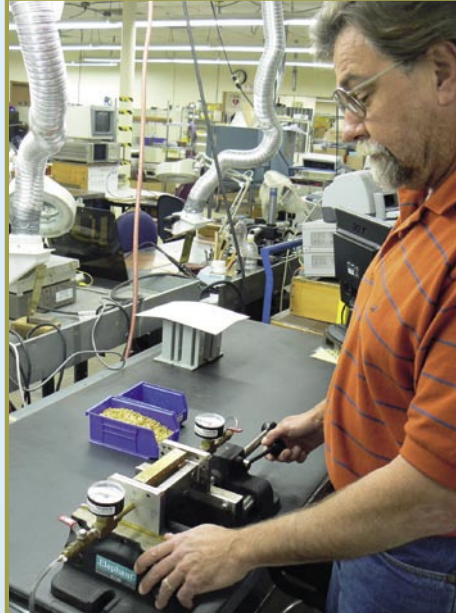
■ Bill Adamo Kalite Kontrol Grup Lideri. Bize hava geçirmez filtre mühürünün basınç testini gösteriyor. "Filtre buraya yerleştiriliyor ve 5 PSI basıncında havayla test ediliyor." Böylece konektör ve kabinin hava geçirmez olup olmadığını kontrol ediyorlar. "En küçük bir sızıntı bile zamanla neme yol açabilir ve filtrenin karakteristiğini değiştirebilir," diyor Bill Adamo, "filtrelerimizi %100 test ederiz!" Tüm müşteriler MFC filtrelerinin yüksek kalitenin tüm gereklerini yerine getirdiğinden emin olabilirler.
