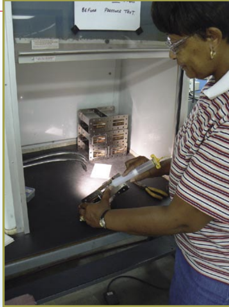
■ Filtredeki sinyal alma probunu Vertell Brantley yerleştiriyor. Kullanılan zamkın üç saat beklemesi gerekli. Filtreler bu odada havadan yalıtılmış olarak tutuluyor. Daha sonra, filtreler hava geçirmez mühürlerle kapatılıyor.
