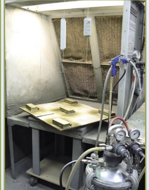
■ MFC neredeyse her şeyi kendisi yapıyor: tamamlanmış filtreler burada koruyucu bir boya ile kaplanıyor.
