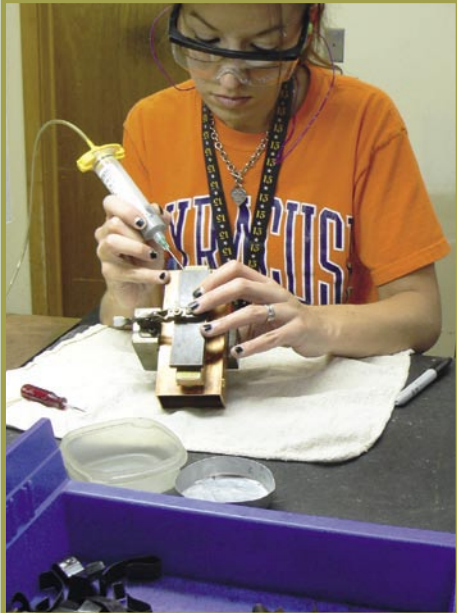
■ Burada filtre mekanik olarak monte ediliyor. MFC görevlisi Melisa Benc, filtreyi havaya firına hazırlıyor...
