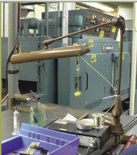
■ ...Gerçek lehimleme işlemi, filtrelerin içinden geçirildiği bu lehimleme firında yapıyor.
